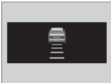
① Champ de détection de l'ACC avec maintien de distance de sécurité à basse vitesse : 120 m
