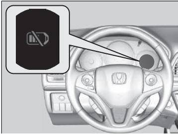
Les signaux sonores d'avertissement peuvent retentir à l'intérieur et/ou à l'extérieur du véhicule pour rappeler au conducteur que la télécommande d'accès sans clé ne se trouve pas dans le véhicule. Si le signal sonore d'avertissement continue alors que la télécommande se trouve de nouveau dans le véhicule, la mettre dans son rayon d'action.
