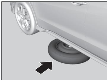
6. Placer la roue de secours (côté voile de jante dirigé vers le haut) sous la caisse du véhicule, près de la roue devant être remplacée.
