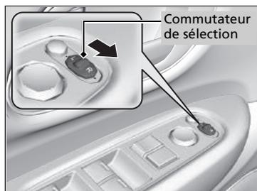
S'il est activé, le rétroviseur côté passager s'incline automatiquement vers le bas lorsque le levier de vitesses est en position **R** ; ceci améliore la visibilité côté passager du véhicule lors d'une marche arrière. Le rétroviseur revient automatiquement sur sa position d'origine lorsque l'on désengage la position **R**.
