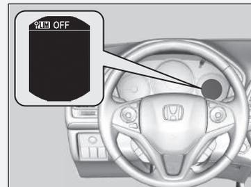
En cas de problème avec le système ou le système de reconnaissance des panneaux de signalisation (TSR) lors de l'utilisation du limiteur de vitesse intelligent, un signal sonore retentit et le témoin **OFF** s'allume. Le limiteur de vitesse intelligent est désactivé.
