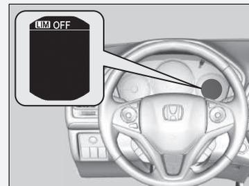
Si le système présente une anomalie lors de l'utilisation du limiteur de vitesse réglable, le signal sonore retentit et le témoin **OFF** s'allume. Le limiteur de vitesse réglable est désactivé.
