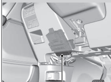
Boîte à fusibles
